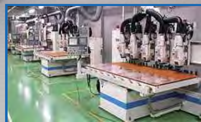
多頭式NC加工機により、同時切削加工！
